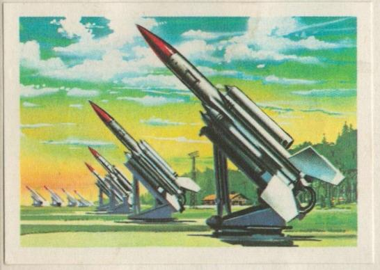
**Bloodhound.** Ceinturé de statoréacteurs, le fuselage de ce missile anglais contient une charge explosive très puissante et une tête chercheuse. Les avions pris en charge sont irrémédiablement condamnés.
